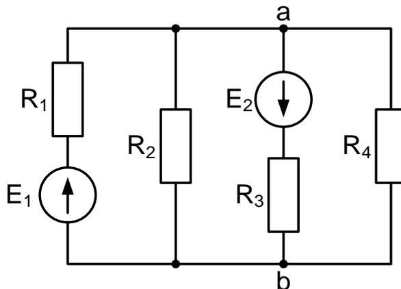
**Задача по теме «Расчет электрических цепей постоянного тока методом контурных токов» (ПЗ № 3)**
